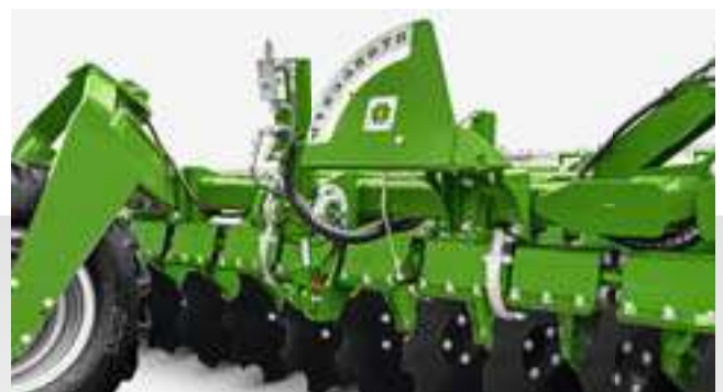
Hydraulische Arbeitstiefenverstellung mit gut ablesbarer Skala
