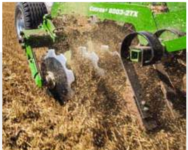
Crushboard mit hydraulischer Tiefenverstellung und übersichtlicher Skala
